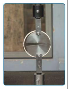
La máxima tensión a la falla. Es la habilidad de las tuberías de resistir la rotura debido a la presión interna.
