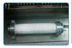
El requerimiento, de acuerdo con la ISO 3127, para este tipo de tubería se exige un impacto mayor al considerado en las normas para tubería de PVC-U tradicional.
